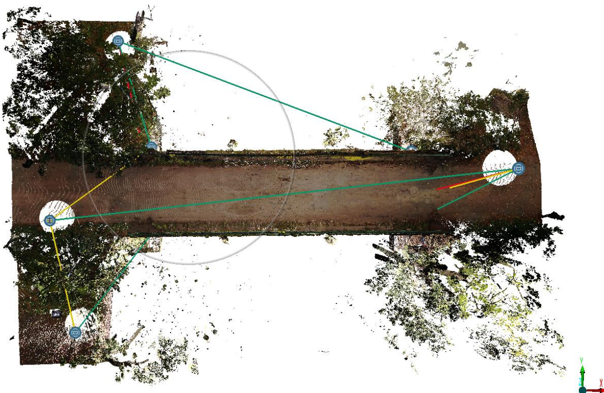
Rys. 2. Rozmieszczenie stanowisk pomiarowych skanera ponad płytą mostu
